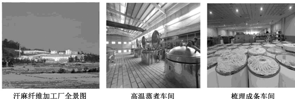
图 8 采用新生产线和加工工艺的汉麻纤维加工厂
